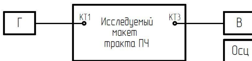
Рис. 3.2. Подключение измерительной аппаратуры к макету тракта ПЧ приемника
